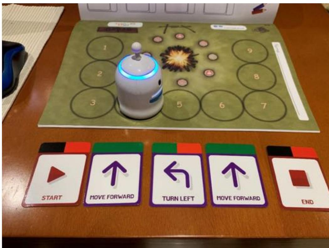
**Ejemplo 2:** Gracias a sus sensores inferiores de color y escalas de grises, es capaz de desplazarse por la línea negra de una rejilla y detectar las intersecciones (no va por el centro de los cuadrados como el BeeBot). Si queremos avanzar a lo largo de la rejilla, necesitaremos esa tarjeta:
