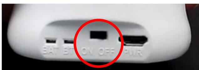
Conectamos el microUSB con el adaptador a 5V y una vez cargado, la luz verde de la batería (BAT) se apagará.
