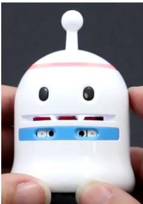
El tiempo de carga del robot es de 25 minutos a través del conector micro usb de su parte trasera. Y esto nos proporcionará unos **90 minutos de autonomía**.
