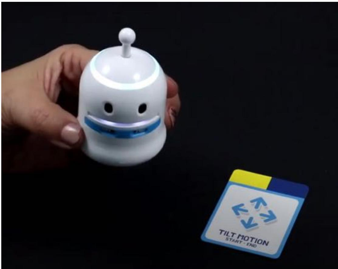
Cada avance o retroceso (inclinarse a True True hacia adelante o hacia atrás), el robot se moverá **5cm**. Y cada giro, derecha o izquierda (inclinando al robot hacia la derecha o izquierda respectivamente), el robot girará **90 grados**.
