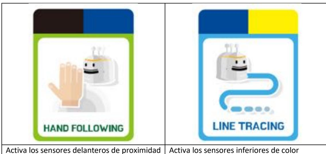
Si queremos que siga una línea negra, debemos activar los sensores inferiores y esto se consigue introduciendo la tarjeta "LINE TRACING" en la boca del robot:
